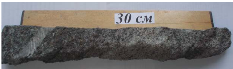
Рис. 1. Одна из борздовых проб полосчатых оливиновых габброноритов, отобранная из коренного обнажения в центральной зоне Калбагдагского массива.
