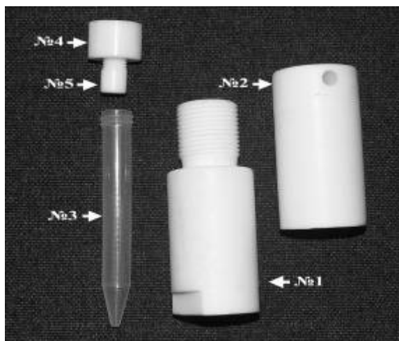
Рис. 1. Устройство автоклава. № 1 и № 2 – разъемный контейнер из фторопласта, в который вставляется стандартная полипропиленовая пробирка на 15 мл (№ 3). Пробирка герметично закрывается фторопластовой комбинированной пробкой (№ 4, № 5).
