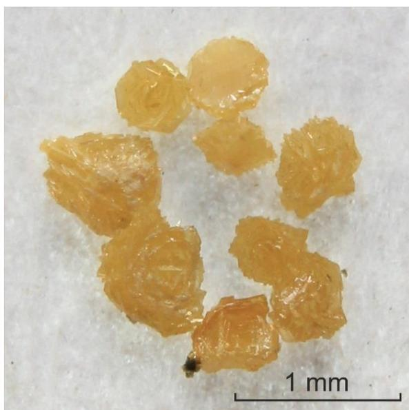
Рисунок 2 – Сферолитоподобные агрегаты сфалерита, полученные в системе с оловом (оп. 5)
