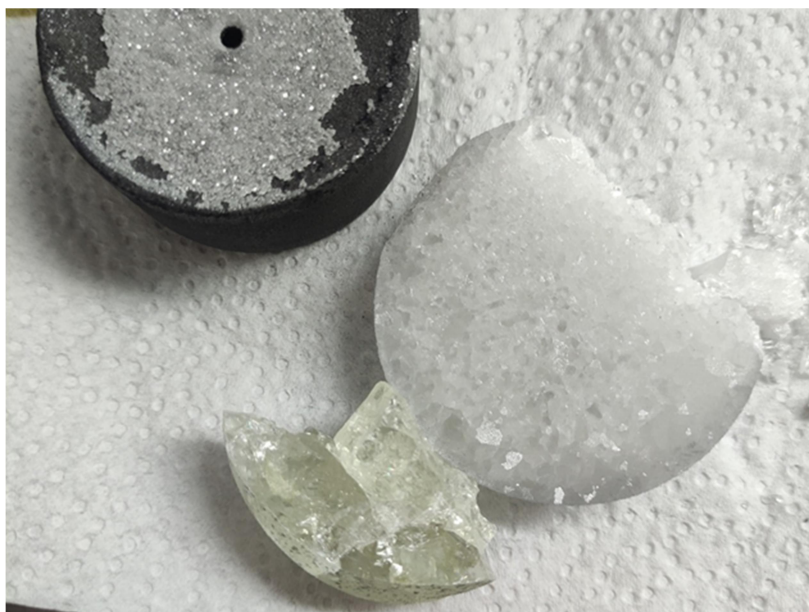
Рисунок 3 – Фотография, сверху – вниз: крышка тигля, \text{CeF}_3 , конденсат, часть були кристаллизованного фторида церия
