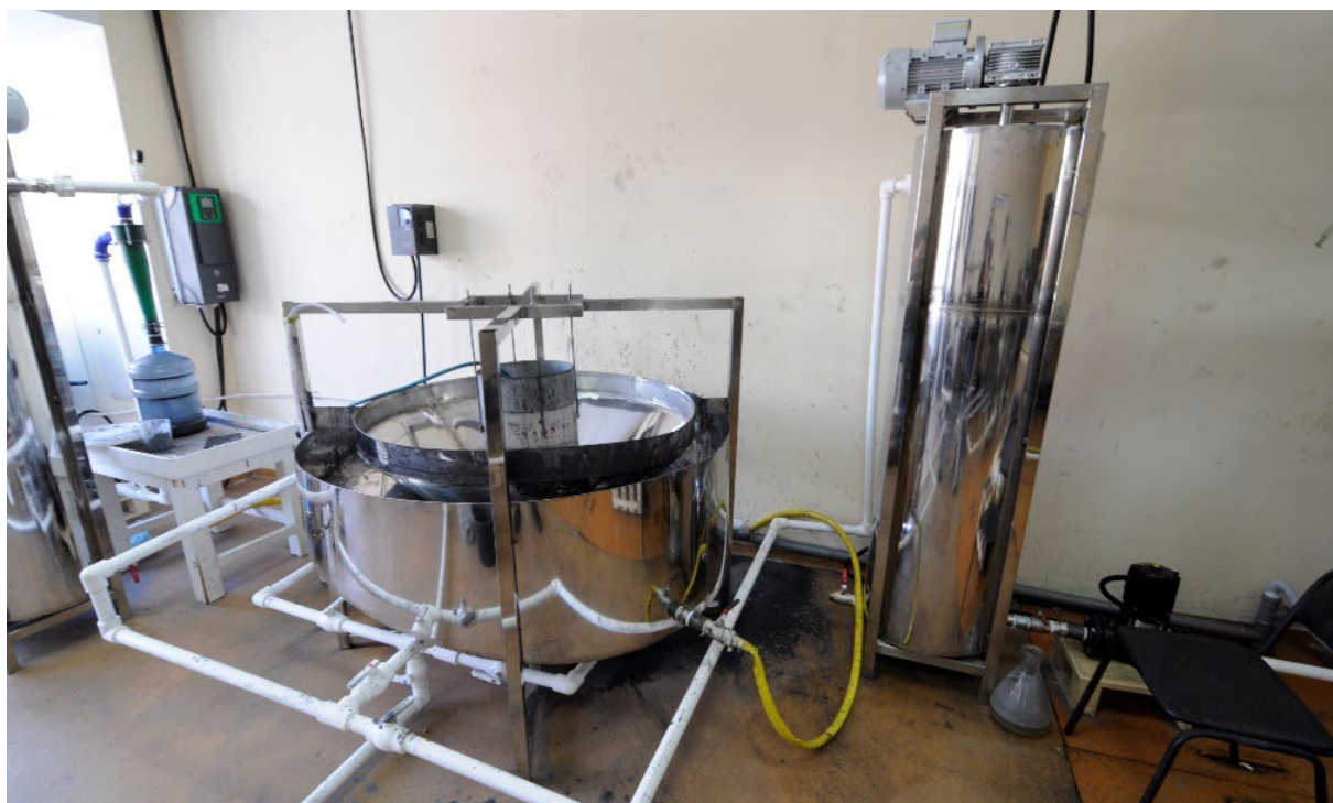
Рисунок 2 – Радиальные флотомашины с пневмогидравлическими аэраторами и устройством дозирования реагентов
