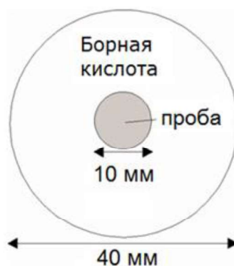
Рисунок 1.1.1 – Схема излучателя, приготовленного прессованием на подложке из борной кислоты
