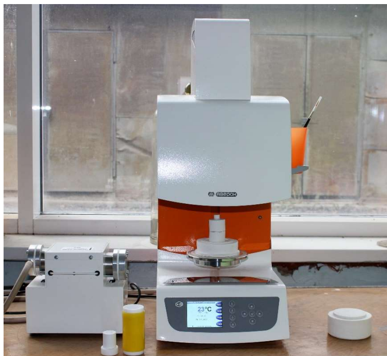
Рисунок 5 – Термопрессовая установка для формирования синтетической породы с нано- и микро-размерными частицами металлов и наноструктурированными минеральными матрицами
