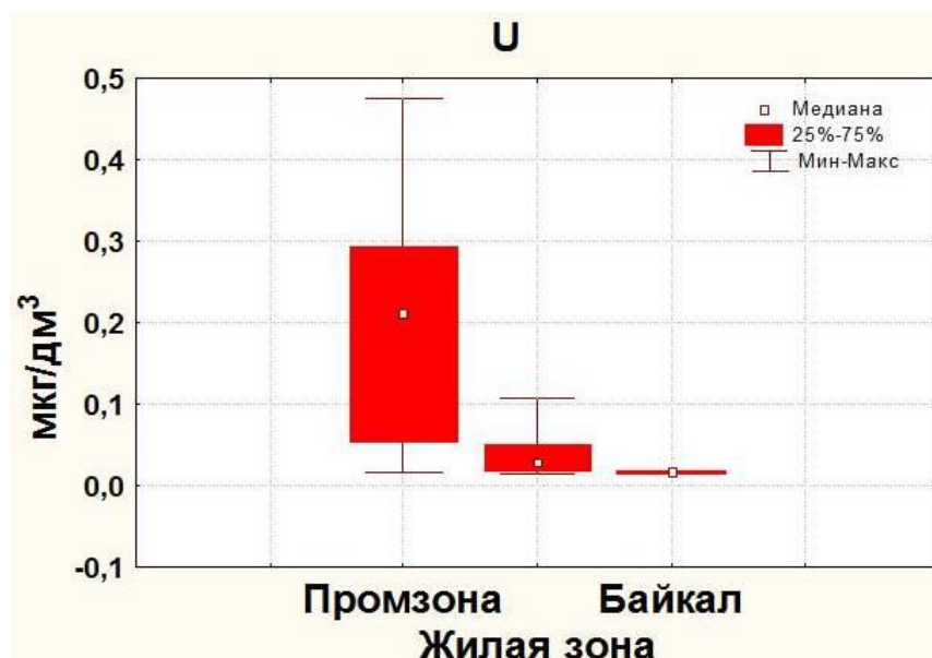
Рисунок 1.1.3 – Содержание урана в снеговой воде промышленной и жилой зонах г. Ангарска и западного побережья озера Байкал.
