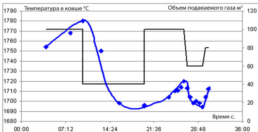
Рис. 13. Изменение температуры в ковше( ^{\circ}\text{C} ) и объема подаваемого газа времени
