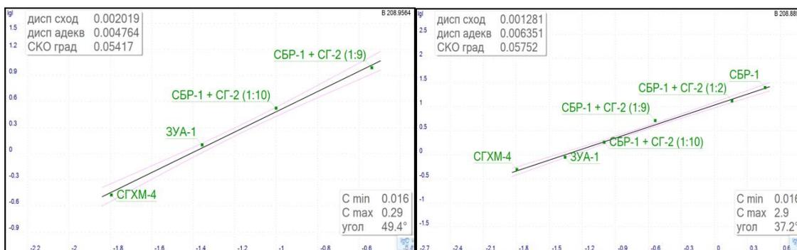
Рис.1 Типичные ГЗ для четырёх линий для определения бора в геологических образцах
