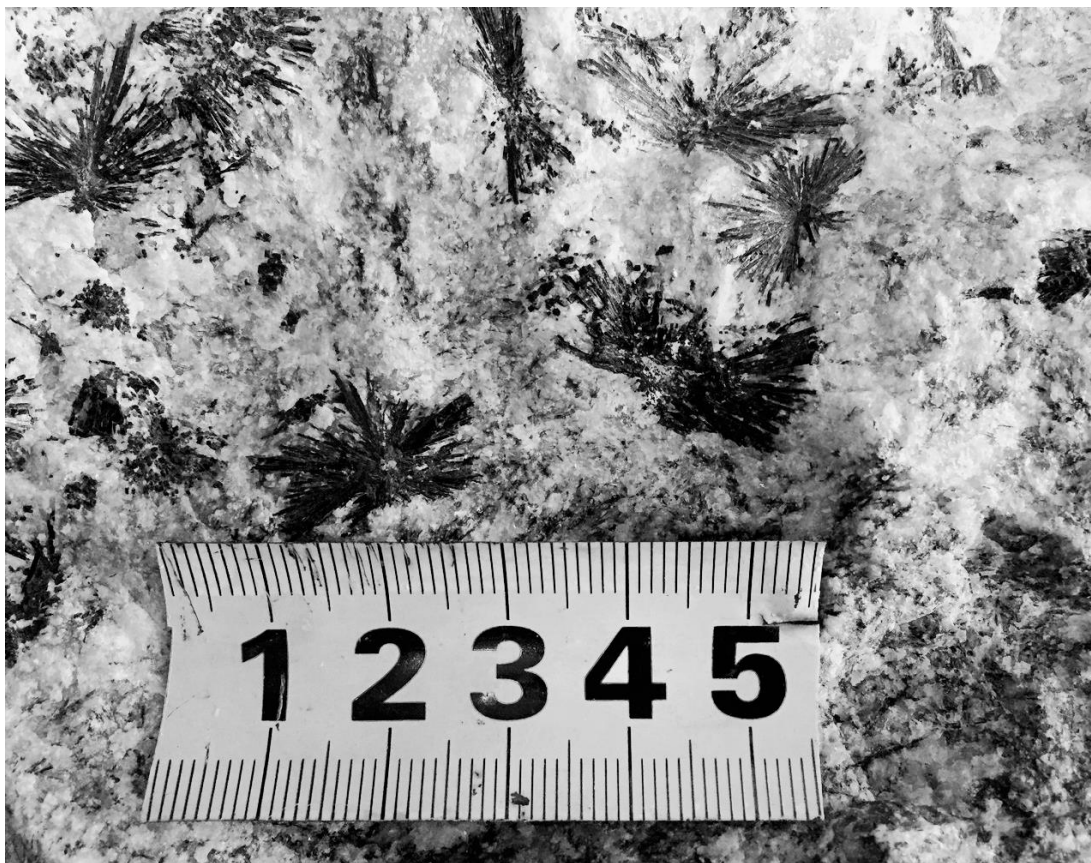
Рис. 2. Пироксен в полевошпатовой породе, раскристаллизованный в виде сферолитов
