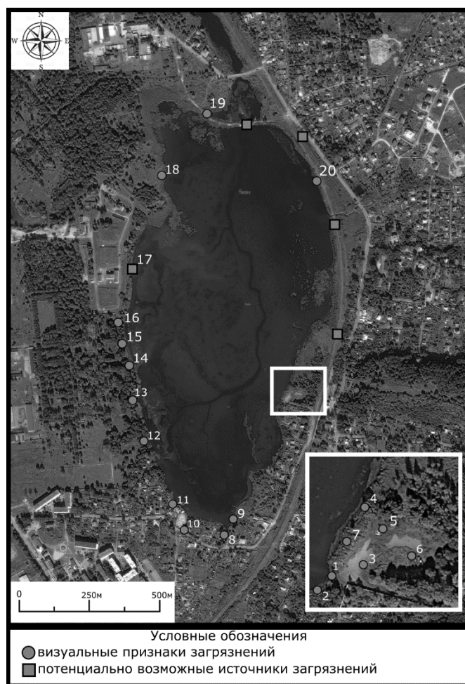
Рис. 1 Схема потенциальных источников загрязнения и визуальных признаков их наличия
