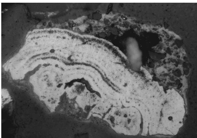
**Рис. 12.** Агрегат гидроксидов Mn и Fe ритмично-полосчатой и колломорфной структуры. Микроскоп. Николи П. Ширина поля зрения рисунка 0.7 мм.
