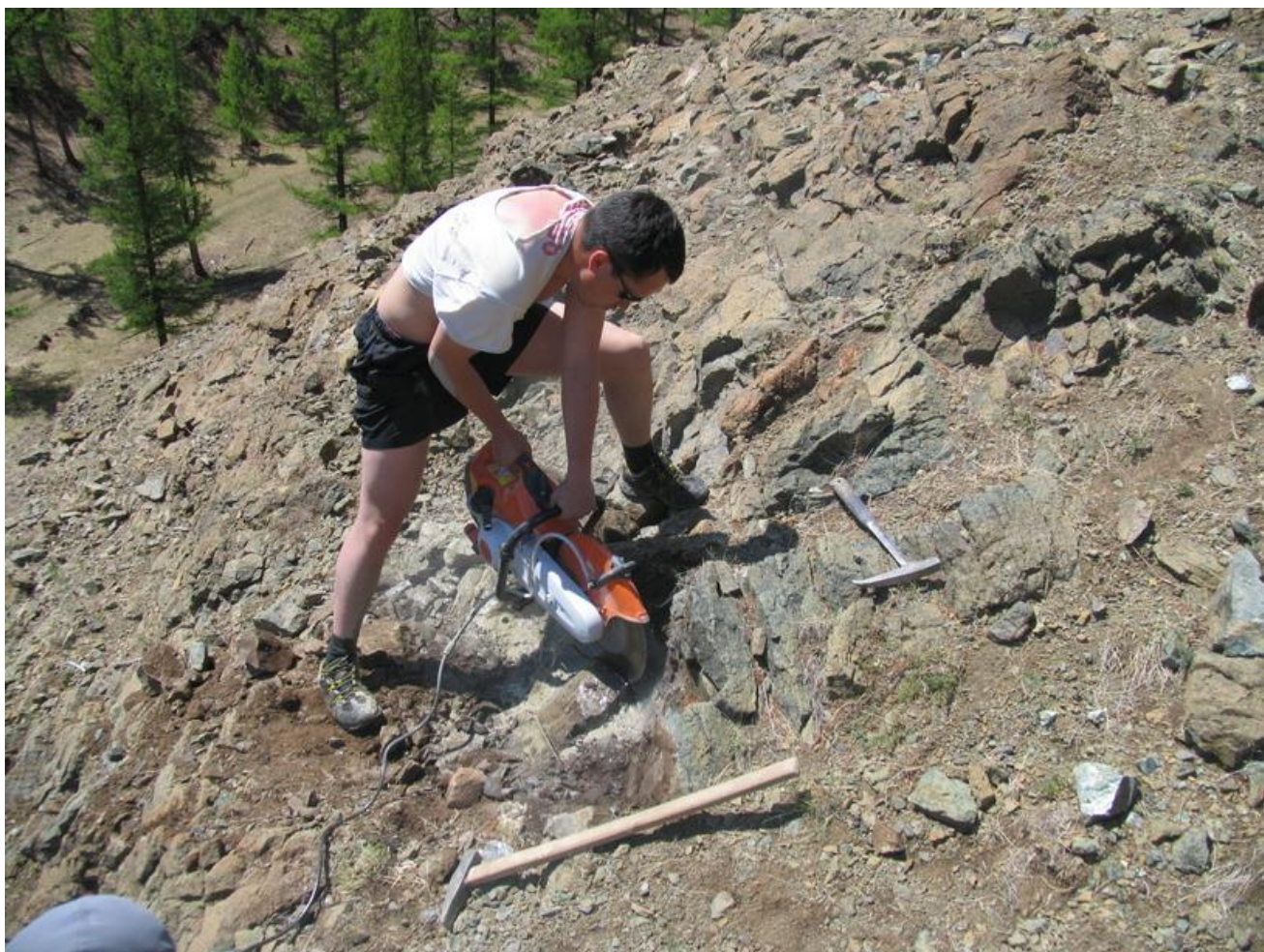
Рис. 3.1. Пример проведения пробоотбора с использованием бензиновой пилы с алмазным диском.
