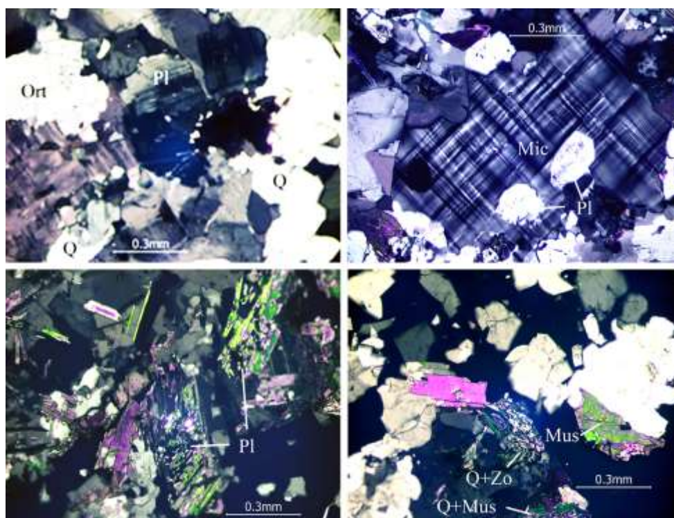
Рис.3. Лейкократовый гранит: а – гипидиоморфная структура; б – микроклин с включениями плагиоклаза и кварца; в – кварц-мусковитовые симплектиты в плагиоклазе; г – кварц-цоизитовые и кварц-эпидотовые симплектиты. Фото шлифа ВУЗ/18 с анализатором.
