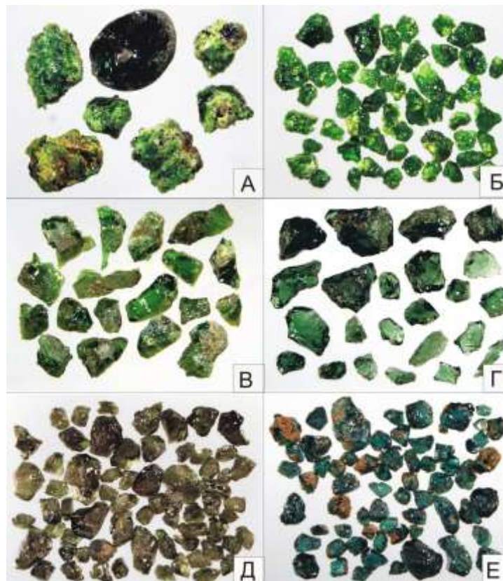
Рис 8. Внешний облик монофракций зелёного граната из кимберлитов трубки Майская: А – класс крупности -4+1 мм; Б-Е – монофракции цветовых разновидностей граната, класс крупности -1+0,25 мм.
