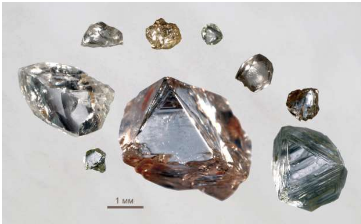
Рис. 7. Внешний облик кристаллов алмаза, обнаруженных в шлиховых и мелкообъёмных пробах из аллювиальных и моренных отложений Устьянского перспективного района.
