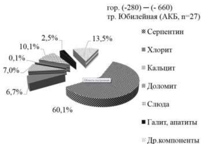
Рис. 5. Содержание минеральных фаз в связующей массе АКБ трубки Юбилейная (глубокие горизонты, – 280 – 660 м).
