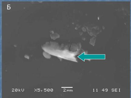
Результаты нормализованного микрозондового анализа интерметаллического соединения Fe и Cr
